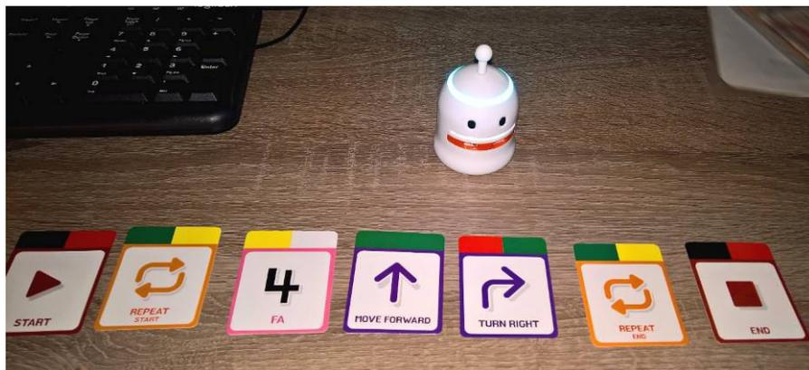
Slika 20. Programiranje robota upotrebom kartica
